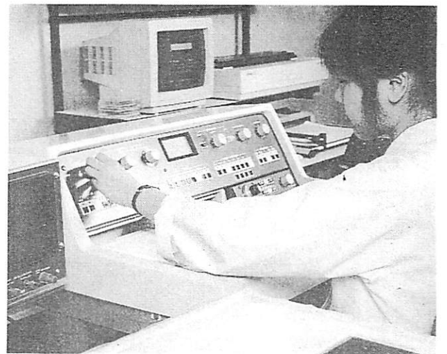
↑ NMR測定装置 有機化合物の分子構造の推定や解明を行う。
