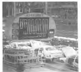
「総合アンドン」 ラインの稼働状況をチェックするための表示板
